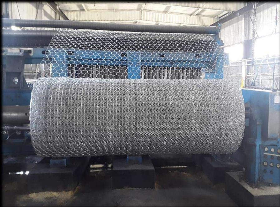
Сетка двойного кручения производится согласно ГОСТ Р 51285-99 на специальных установках путем свивки двух проволок с цинковым или цинк-алюминиевым покрытием с образованием шестиугольных ячеек. Узел сетки имеет не менее двух витков, отсюда название сетки двойного кручения. Сетка, оцинкованная двойного кручения имеет ряд преимуществ перед другими типами стальных сеток с покрытием:
